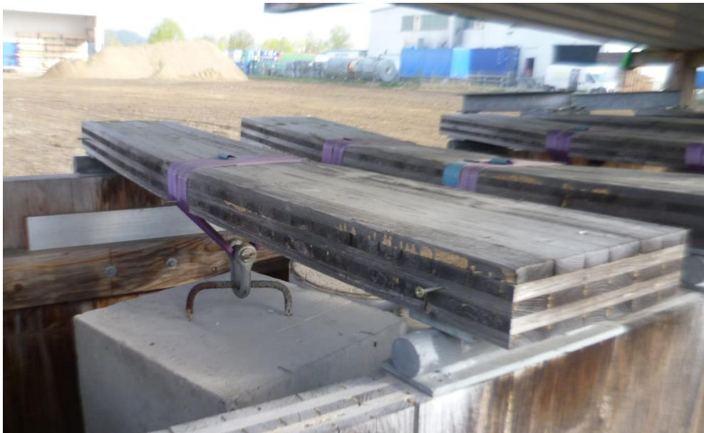
Bild 6 Träger mit Einzellast in Feldmitte (Reihe 3)
