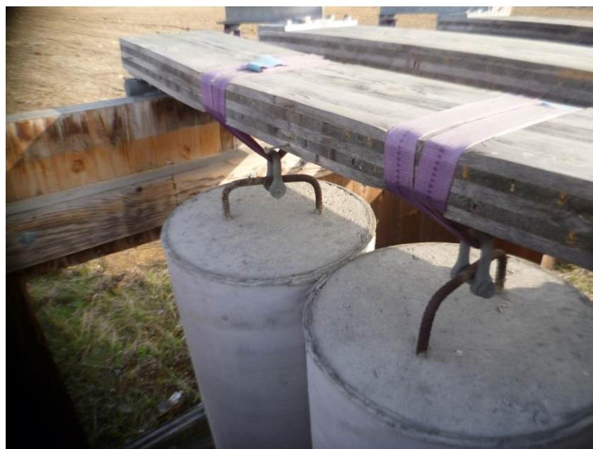
Bild 5 Träger mit Drittelpunktbelastung (Reihe 2)
