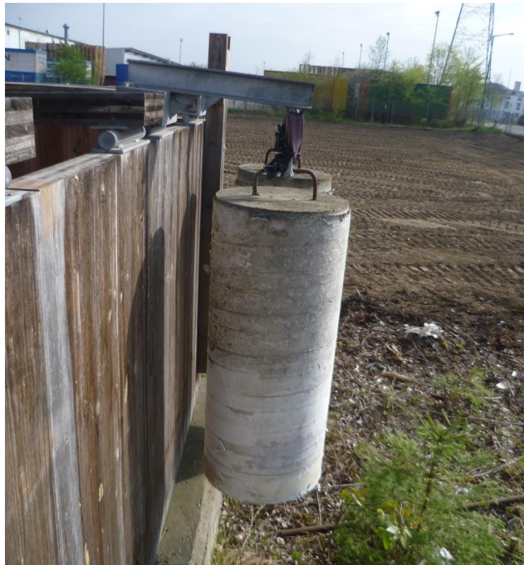
Bild 4 Betongewicht bei Träger mit konstanter Momentenbeanspruchung (Reihe 1)
