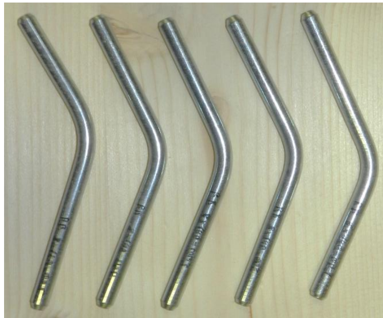
Bild 6.3 Stabdübel der Prüfsreihe RB 8 x 140 nach der Biegeprüfung in der Drehmoment-Prüfmaschine der Firma Schatz GmbH
