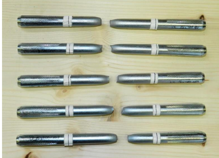
Bild 6.2 Stabdübel der Prüfsreihe VK 16/200 nach den Zugversuchen mit deutlicher Einschnürung und den aufgeklebten Markierungen für das optische Messsystem
