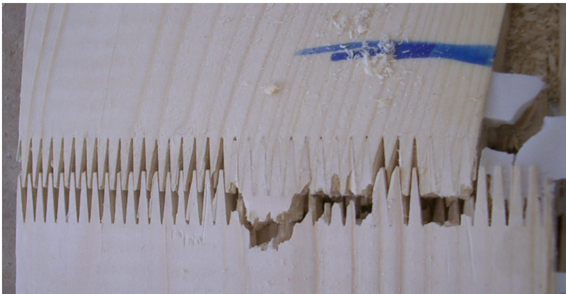
Bild 3-13 Faserabweichung im Bereich der Keilzinkenverbindung
