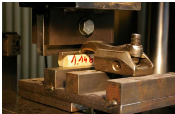
Abbildung 1: Prüfung von Bohrkernen (links: Prüfvorrichtung, rechts: Scherprobe nach dem Versuch).
