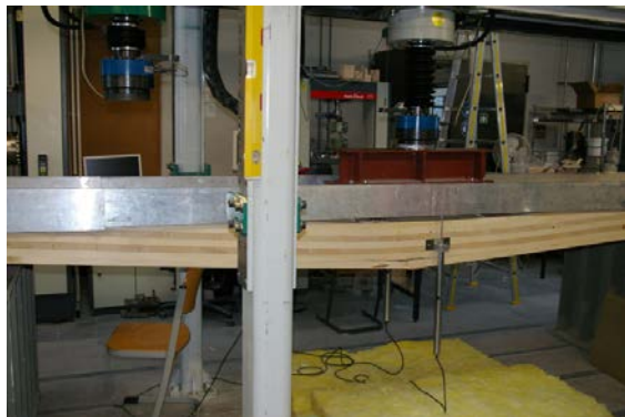
Abbildung 5: Versuch zur Ermittlung der Biegefestigkeit von Brettsperrholzbauteilen.
