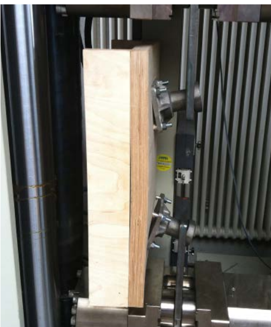
Abbildung 3: Nocken-Aufhängung nach Erreichen der Höchstlast.
