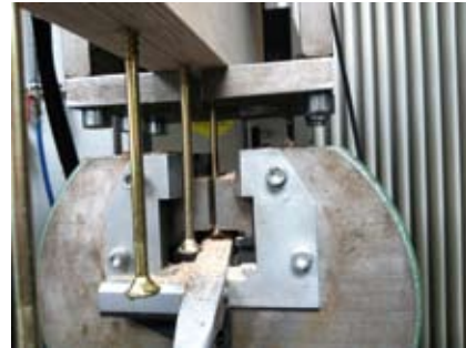
Abb. 3: Versuch auf Herausziehen einer Schraube.
