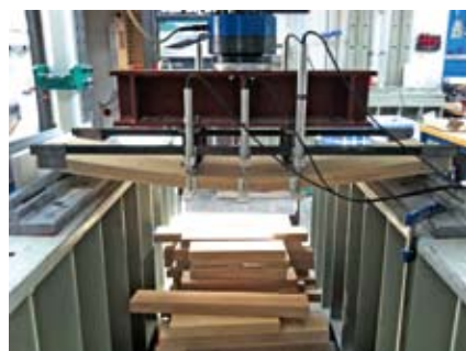
Abb. 2: Biegeversuch an einer Sperr- holzplatte (Furnierplatte).
