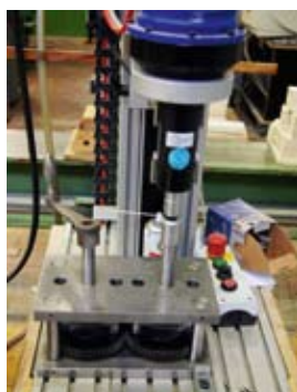
Abb. 1: Versuchsvorrichtung zur Ermittlung des Fließmomentes von stiftförmigen Verbindungsmitteln.
