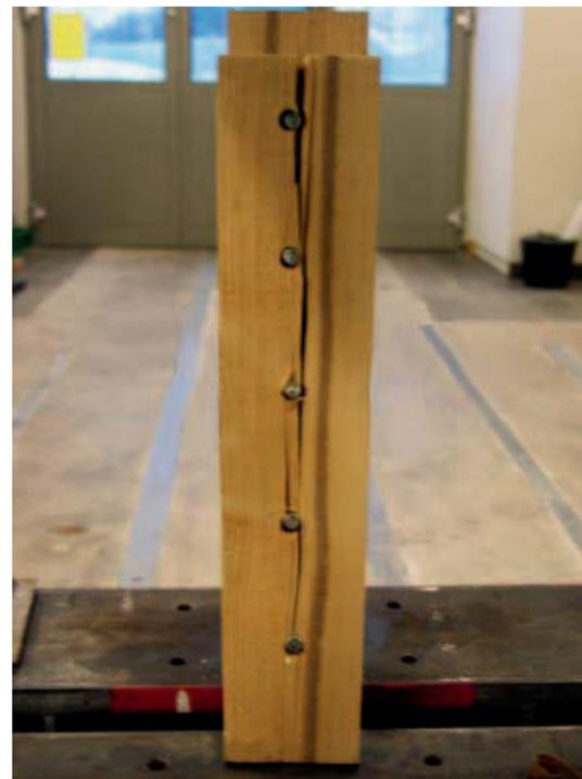
Abb. 4 und 5: Aufspalten des Holzes bei in Faserrichtung hintereinander liegenden Verbindungsmitteln.
