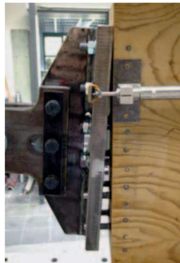
Abb. 5b: Versagensform des Anschlusses.
