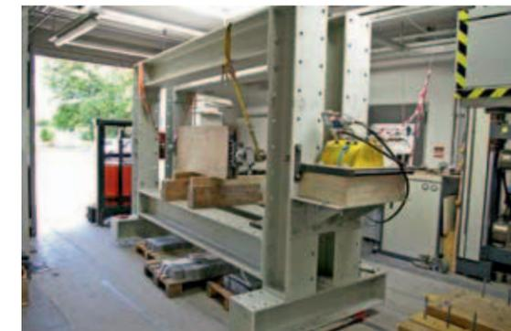
Abb. 3: Prüfraumen mit eingebautem Prüfkörper.
