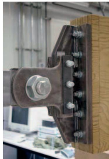
Abb. 5a: Gewindestangenpaket mit Stahlanschluss.
