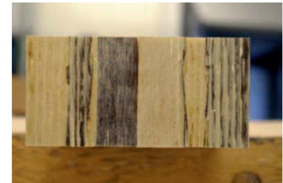
Abb. 1b: Scherfläche nach der Prüfung.
