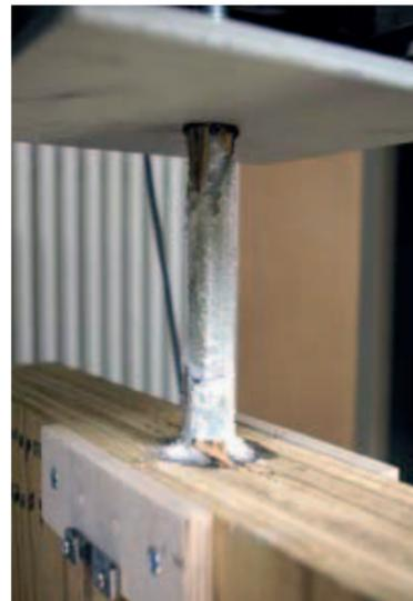
Abb. 4b: Versagen der Klebeverbindung.
