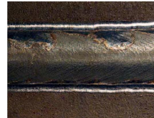
Schweißnaht nach dem Hämmern; beidseits der Nahtoberfläche ist die Vertiefung zu erkennen, die durch das Hämmern entstanden ist (Foto: Weich).
