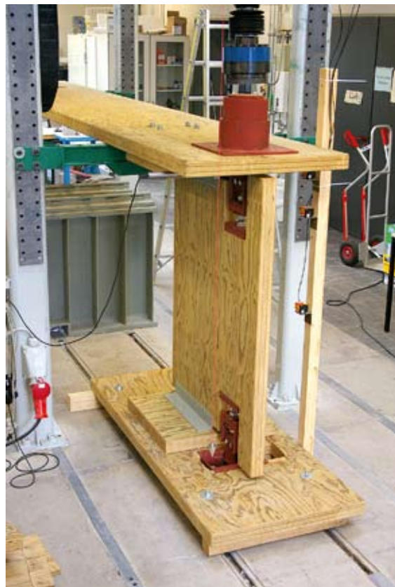
Bild 5: Prüfkörper im Knickversuch
