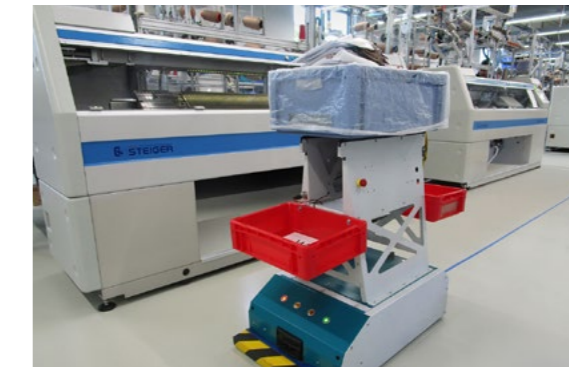
Das Fahrerlose Transportsystem (FTS) LEO Locative fährt im Neubau die Ware von einer zur nächsten Produktionsstation.
