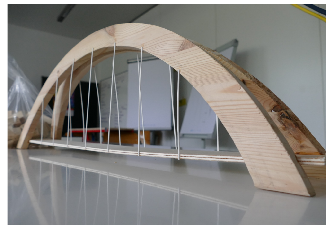
Modell einer Bogenbrücke (Bild: HSA_transfer)
