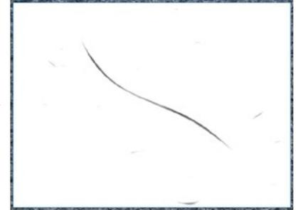
Das Hintergrundrauschen wird unterdrückt, so dass ausschließlich Kratzerlinien extrahiert werden.
