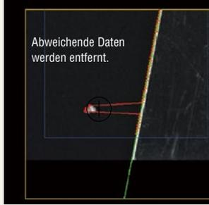
Anhand der Positionsdaten von mehreren Kanten, die auf der Kantenfläche einer Platine erfasst wurden, kann eine Näherungslinie errechnet werden. Daraus können Positions- und Winkeldaten präzise berechnet werden.
