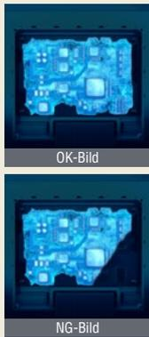
Prüfung auf fehlerhafte Sicherungsmontage
