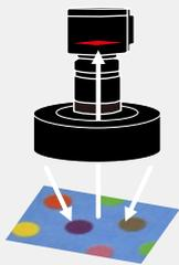
Der Bildsensor mit vorgeschaltetem Farbfilter empfängt das vom Prüfobjekt reflektierte weiße Licht. Anhand dieser Daten wird daraufhin ein Farbbild erstellt.
