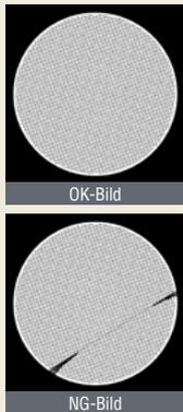
Überprüfung des Dichtmittelauftrags
