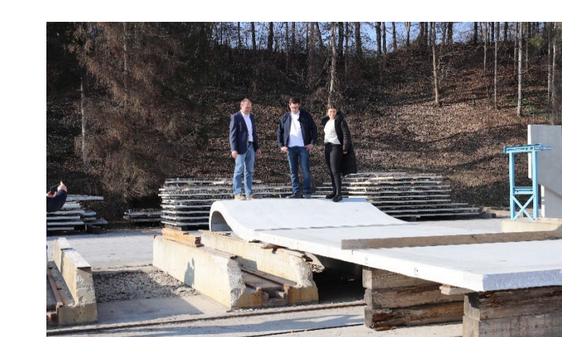
Bündelung von Expertisen für den Bau der Surfwellen: Materialien (100%-recycelte Gesteinskörnung, Carbongeflecht), passgenau konstruierte Schalttafeln und die Betonage im Betonwerk Lauter
