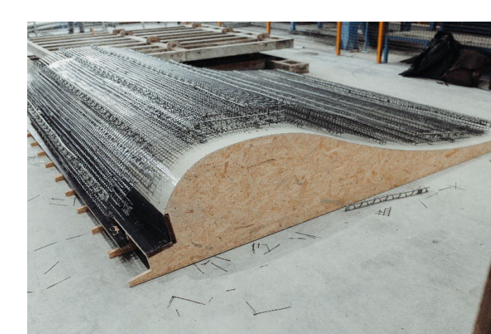
Bündelung von Expertisen für den Bau der Surfwellen: Materialien (100%-recycelte Gesteinskörnung, Carbongeflecht), passgenau konstruierte Schalttafeln und die Betonage im Betonwerk Lauter
