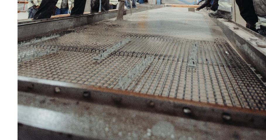
Bündelung von Expertisen für den Bau der Surfwellen: Materialien (100%-recycelte Gesteinskörnung, Carbongeflecht), passgenau konstruierte Schalttafeln und die Betonage im Betonwerk Lauter
