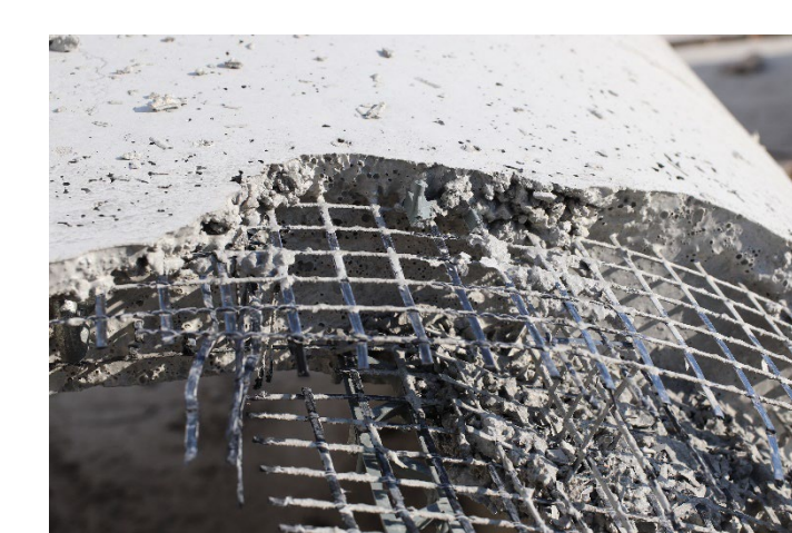
Bündelung von Expertisen für den Bau der Surfwellen: Materialien (100%-recycelte Gesteinskörnung, Carbongeflecht), passgenau konstruierte Schalttafeln und die Betonage im Betonwerk Lauter
