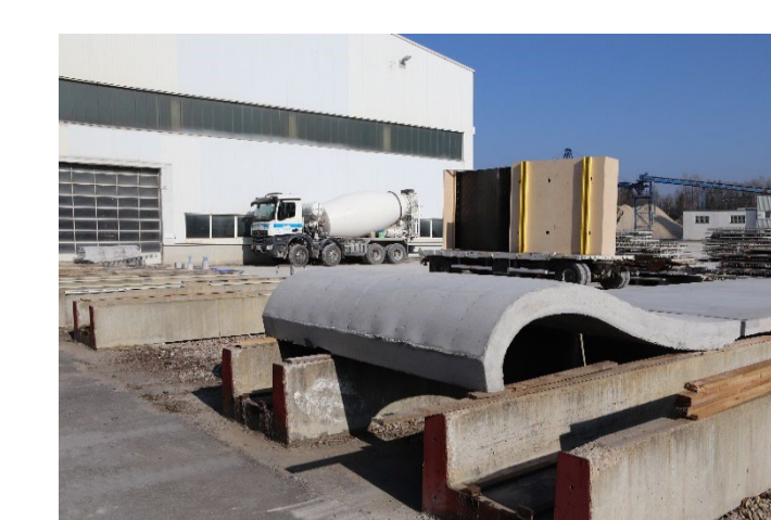
Bündelung von Expertisen für den Bau der Surfwellen: Materialien (100%-recycelte Gesteinskörnung, Carbongeflecht), passgenau konstruierte Schalttafeln und die Betonage im Betonwerk Lauter
