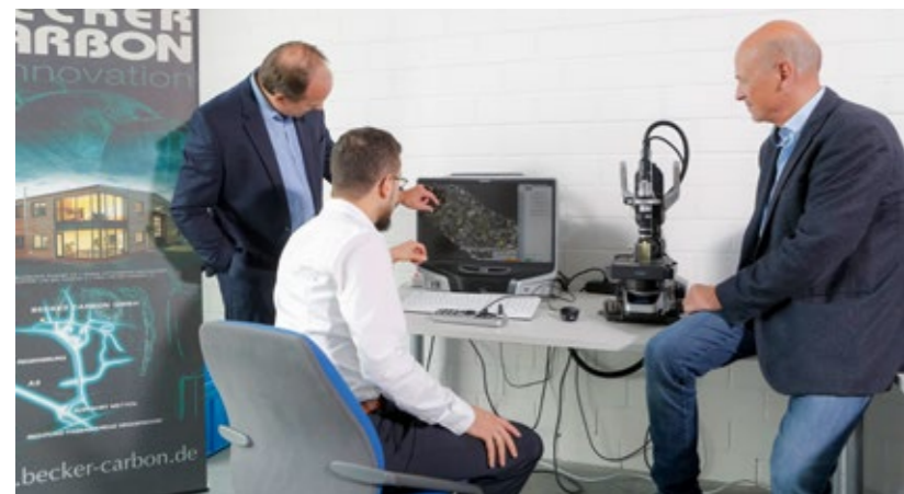
Speziell für Verbundwerkstoffe steht den Wissenschaftlern ein 5-Achs-Ultraschallbearbeitungszentrum zur Verfügung.
