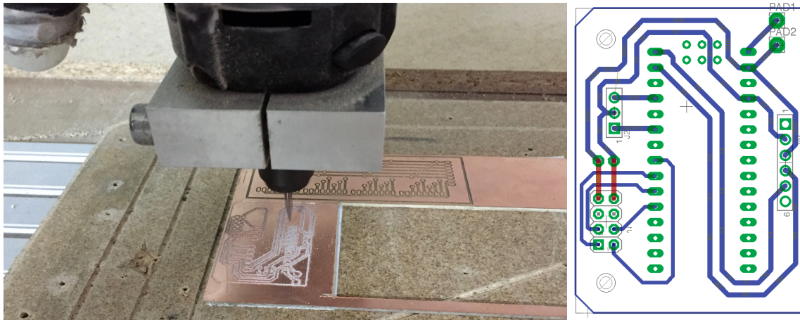
Abbildung 10 I/O Platine in der Herstellung beim Fräsen und als Layout
