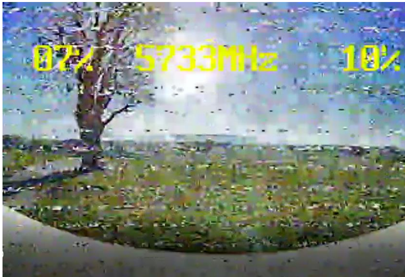
Abbildung 43: Skydroid kleine Patchantenne bei 400mW
