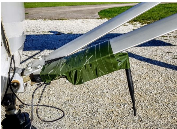
Abb. 5-4: Befestigung der mittleren Antenne
