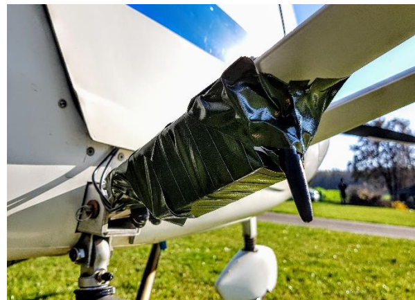
Abb. 5-5: Befestigung der kleinen Antenne
