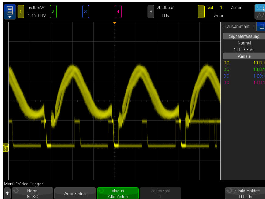
Abbildung 30 Triggerung auf alle Zeilen
