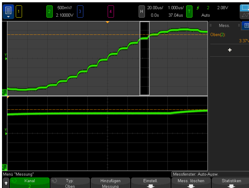
Abbildung 48 Isolationsbereich für Dachmessung („Top“)
