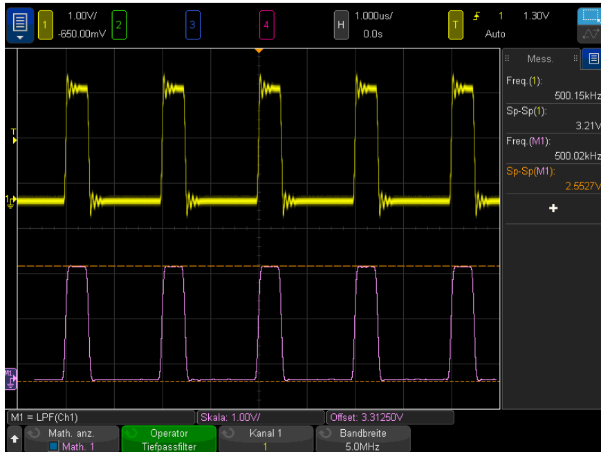
Abbildung 16 Beispiel für Tiefpassfilter
