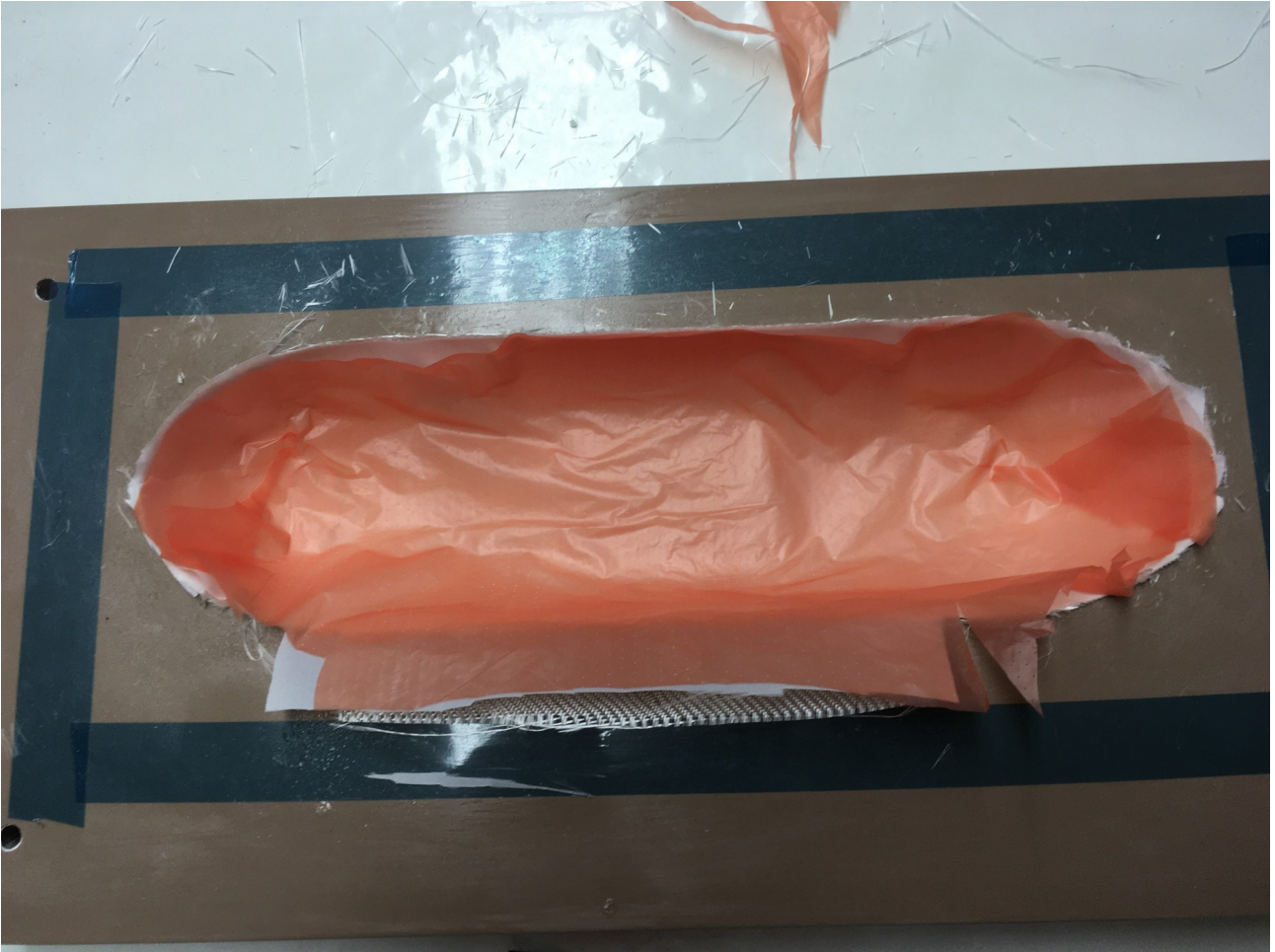
Abbildung 6: Zwei Lagen 160g/m 2 Glasfaser, Abreißgewebe und Lochfolie
