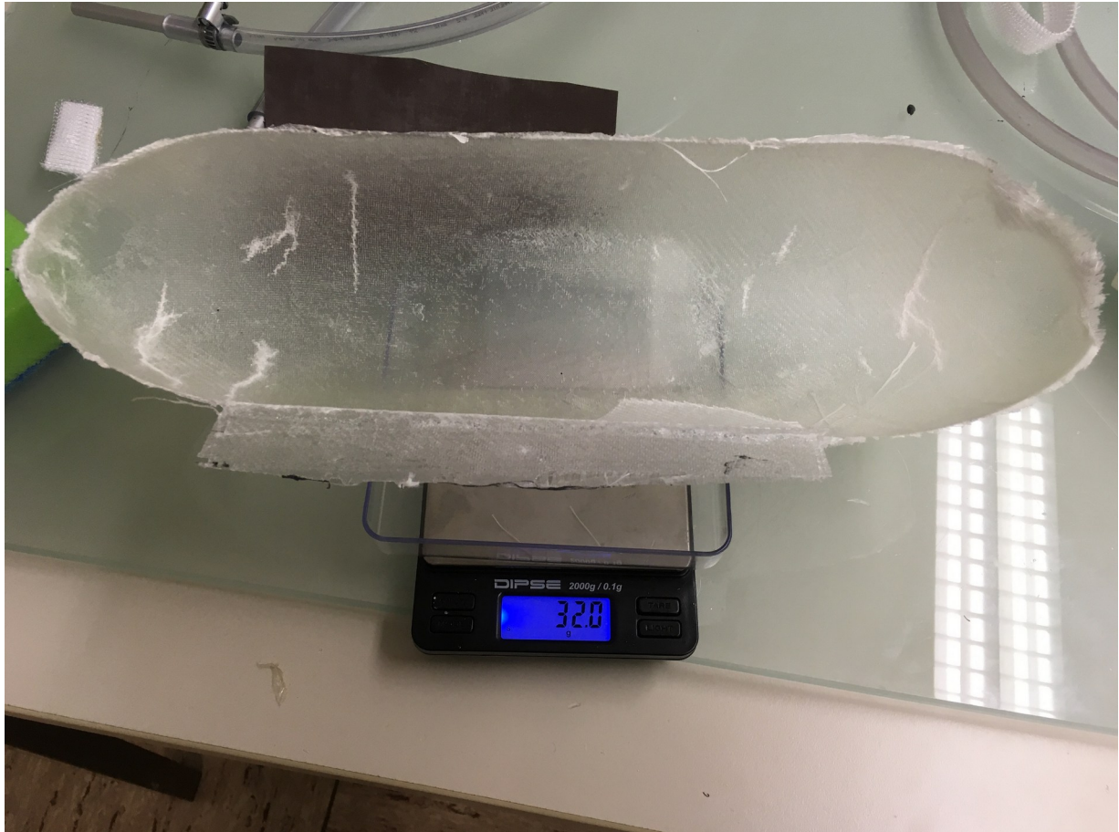
Abbildung 13: Bauteil mit 32g Gewicht. Weißbruch beim Entformen.
