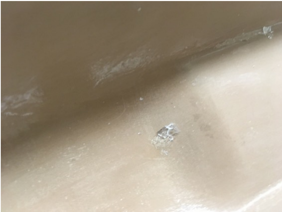
Abbildung 16: Harzreste in Rundung links mitte und oben mitte.
