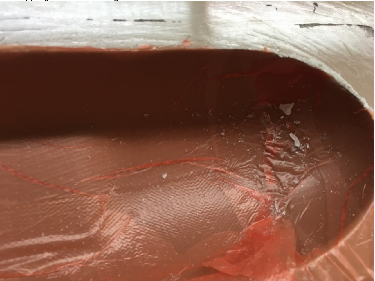
Abbildung 12: Bauteil rechts nach Entfernen der VAP Membran
