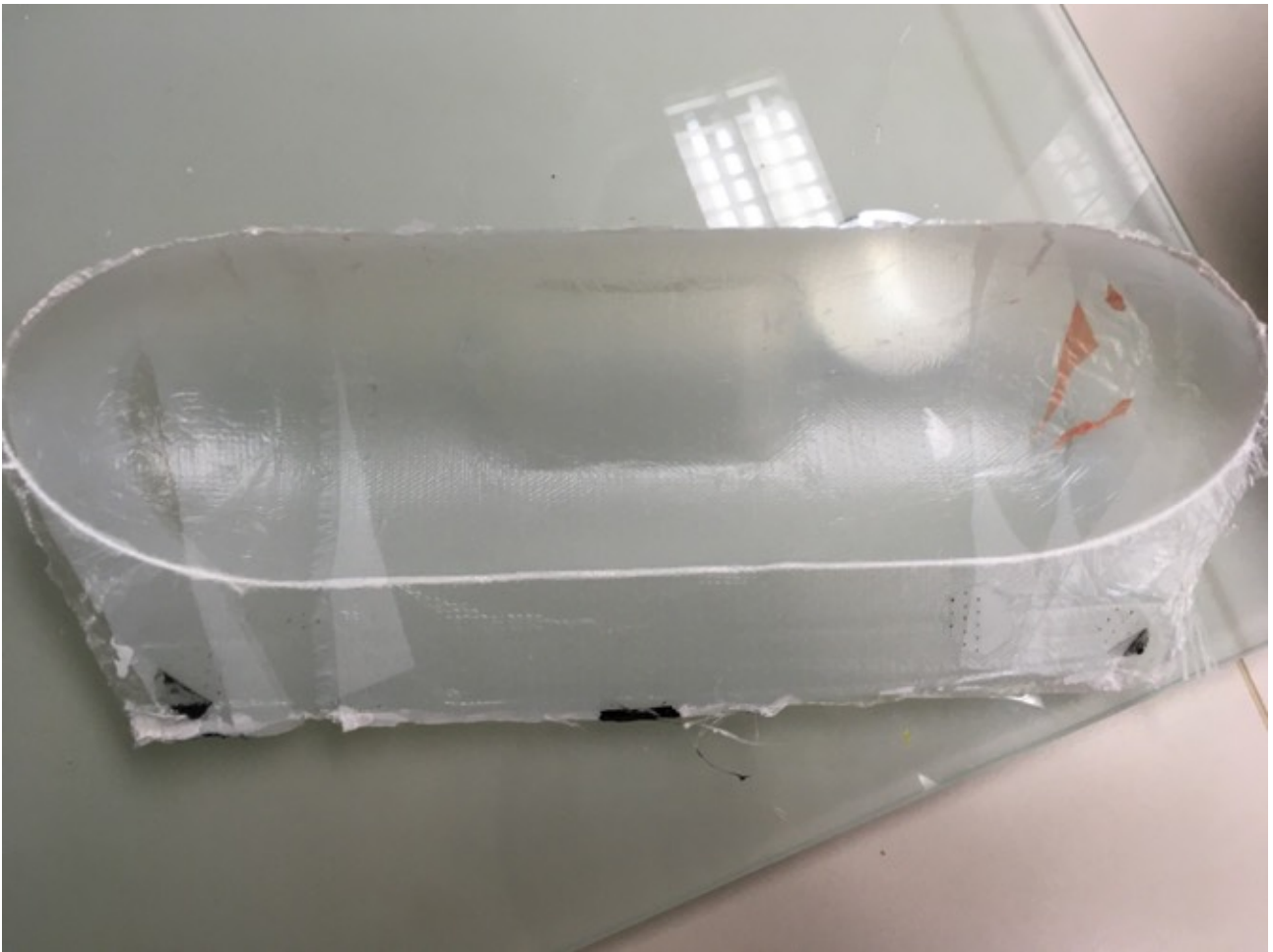
Abbildung 18: Bauteil nach der Entformung mit Abreißgewebe
