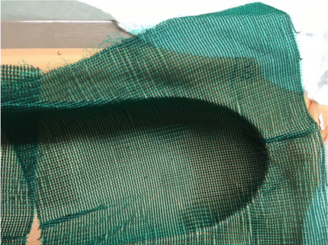
Abbildung 8: Bauteil rechts nach Entfernen der Vakuumfolie
