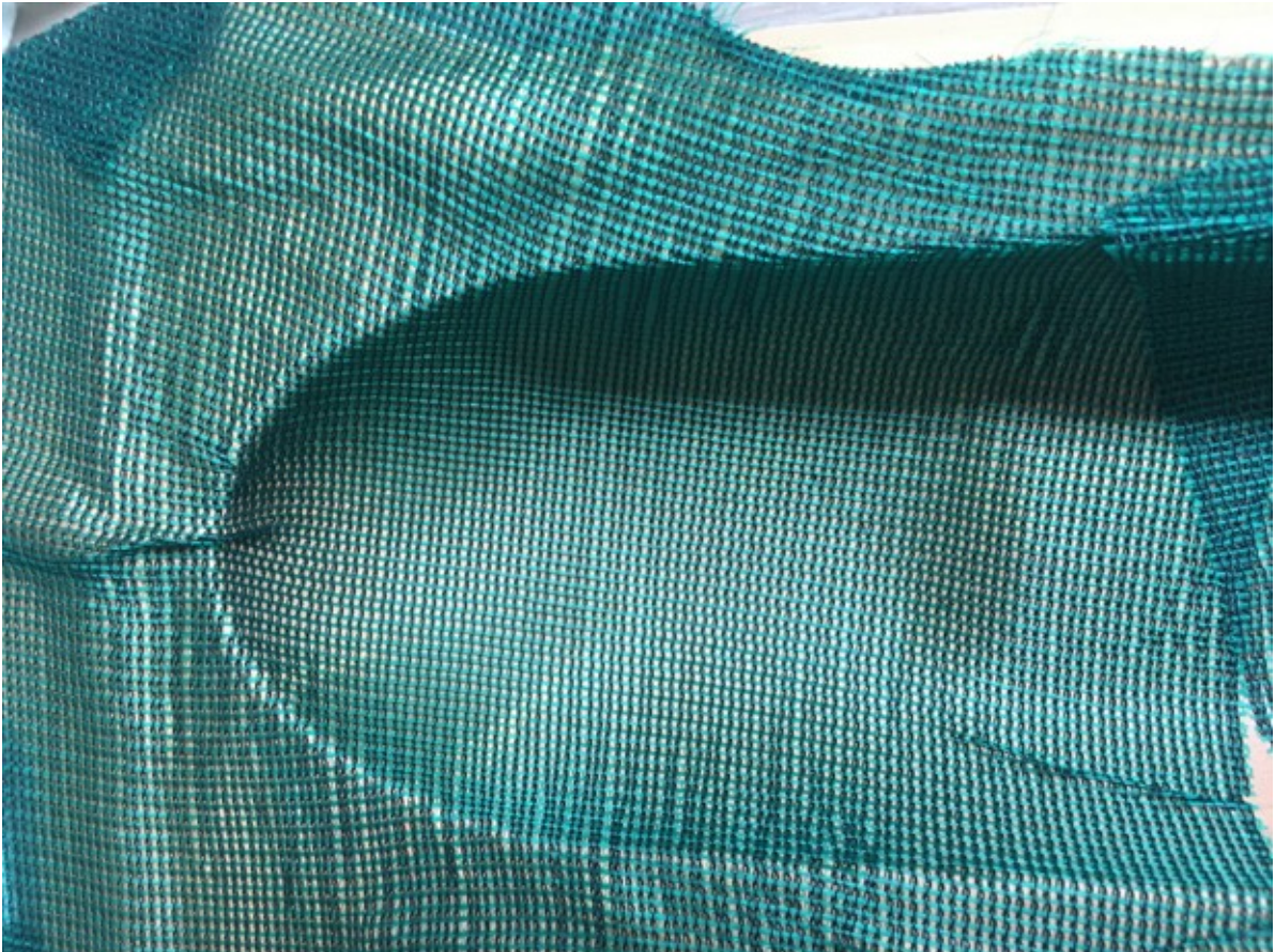
Abbildung 9: Bauteil links nach Entfernen der Vakuumfolie
