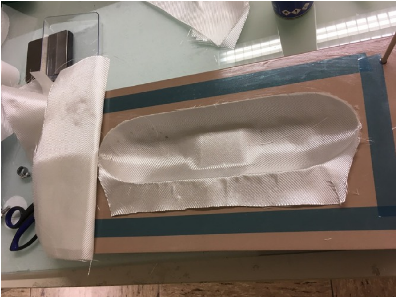
Abbildung 1: GFK Geweber über den Rand geführt um den Harzfluss zu verbessern
