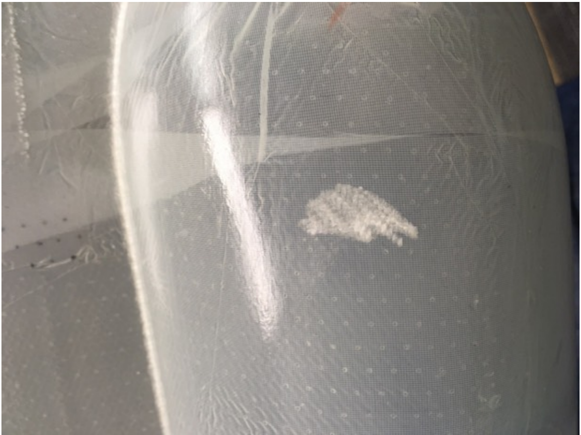
Abbildung 22: Delaminierung beim Ausbau aus der Form
