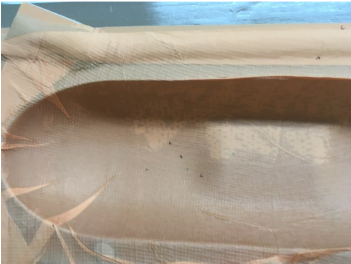
Abbildung 11: Bauteil links VAP Membran nach Entfernen der OM70 Fließhilfe
