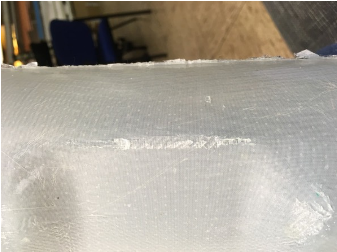
Abbildung 21: Abgebrochenes Harz Rundung in der Mitte
