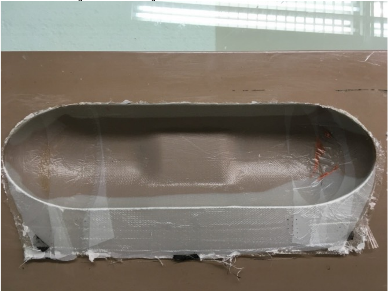
Abbildung 14: Bauteil nach Entfernen der Lochfolie.
