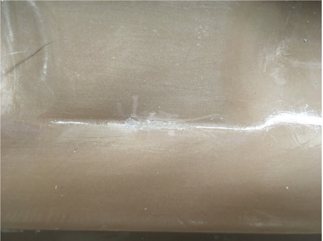
Abbildung 17: Harzreste in der Rundung mitte unten
