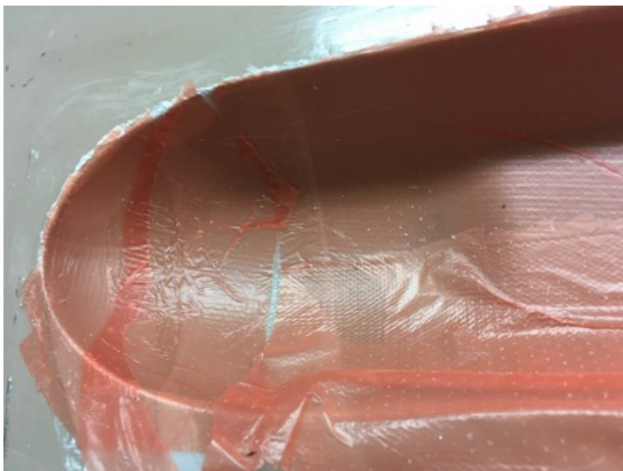
Abbildung 13: Bauteil links nach Entfernen der VAP Membran
