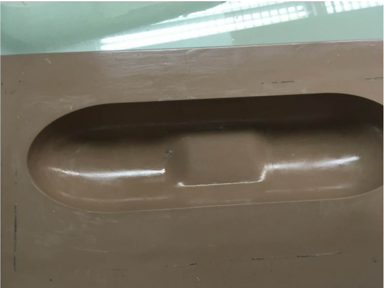
Abbildung 15: Form nach Entnahme des Bauteils mit Harzresten
