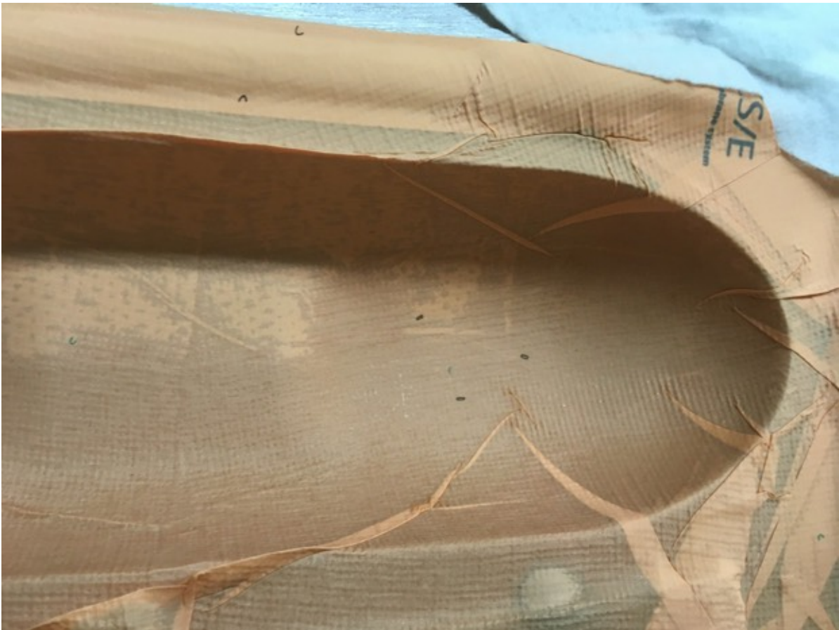
Abbildung 10: VAP Membran Bauteil rechts nach Entfernen der OM70 Fließhilfe
