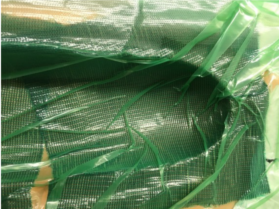
Abbildung 6: Bauteil rechts unter Vakuum
