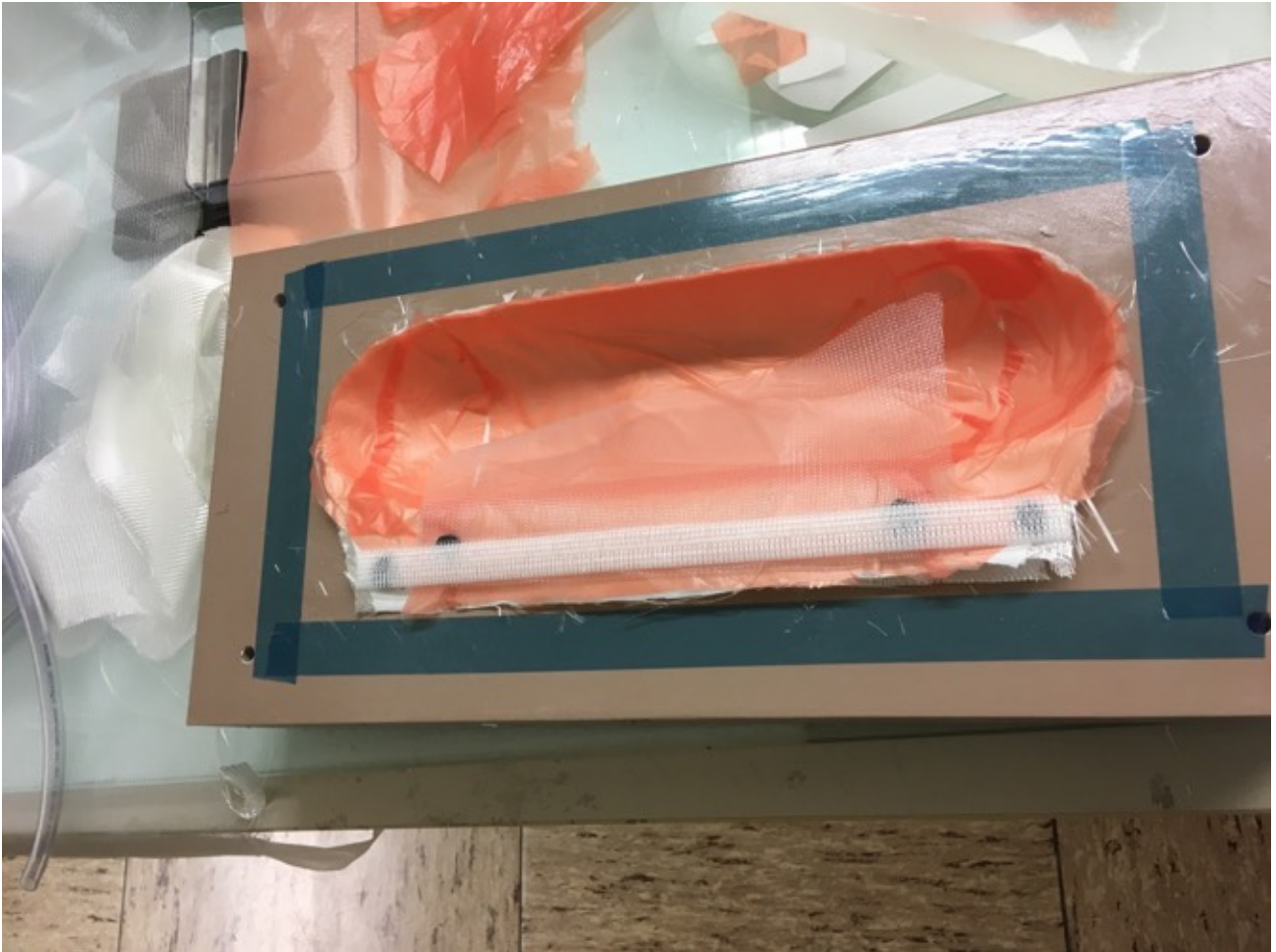
Abbildung 2: Dianet Fließhilfe und 20mm Fließkanal auf Abreißgewebe und Lochfolie
