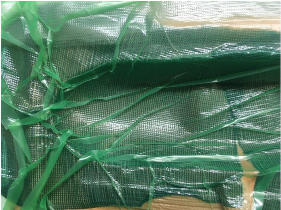
Abbildung 7: Bauteil links unter Vakuumdruck
