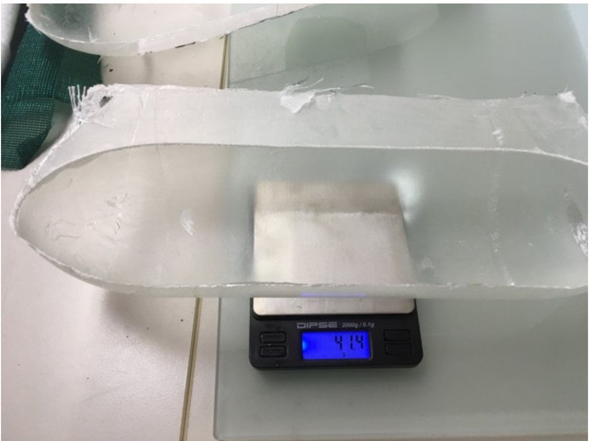
Abbildung 23: Bauteil nach Entfernen des Abreißgewebes mit 41,4g Gewicht
