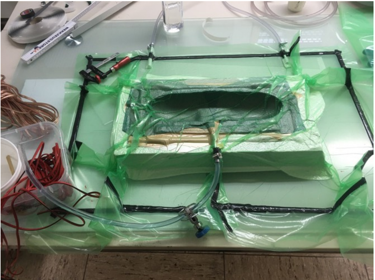
Abbildung 5: Kompletter Aufbau nach dem Harzeinlass
