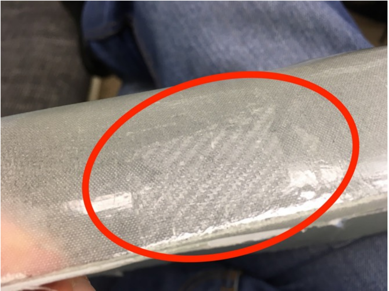
Abbildung 24: Harz abgeplatzt bis auf Faser - gleiche Stelle
