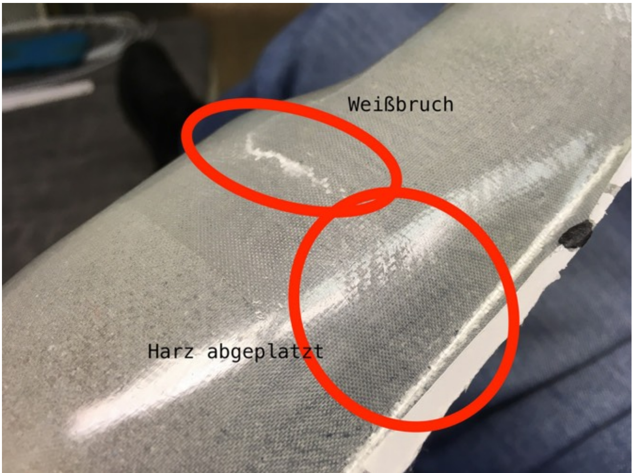
Abbildung 25: Harz abgeplatzt an der zweiten Stelle und Weißbruch
