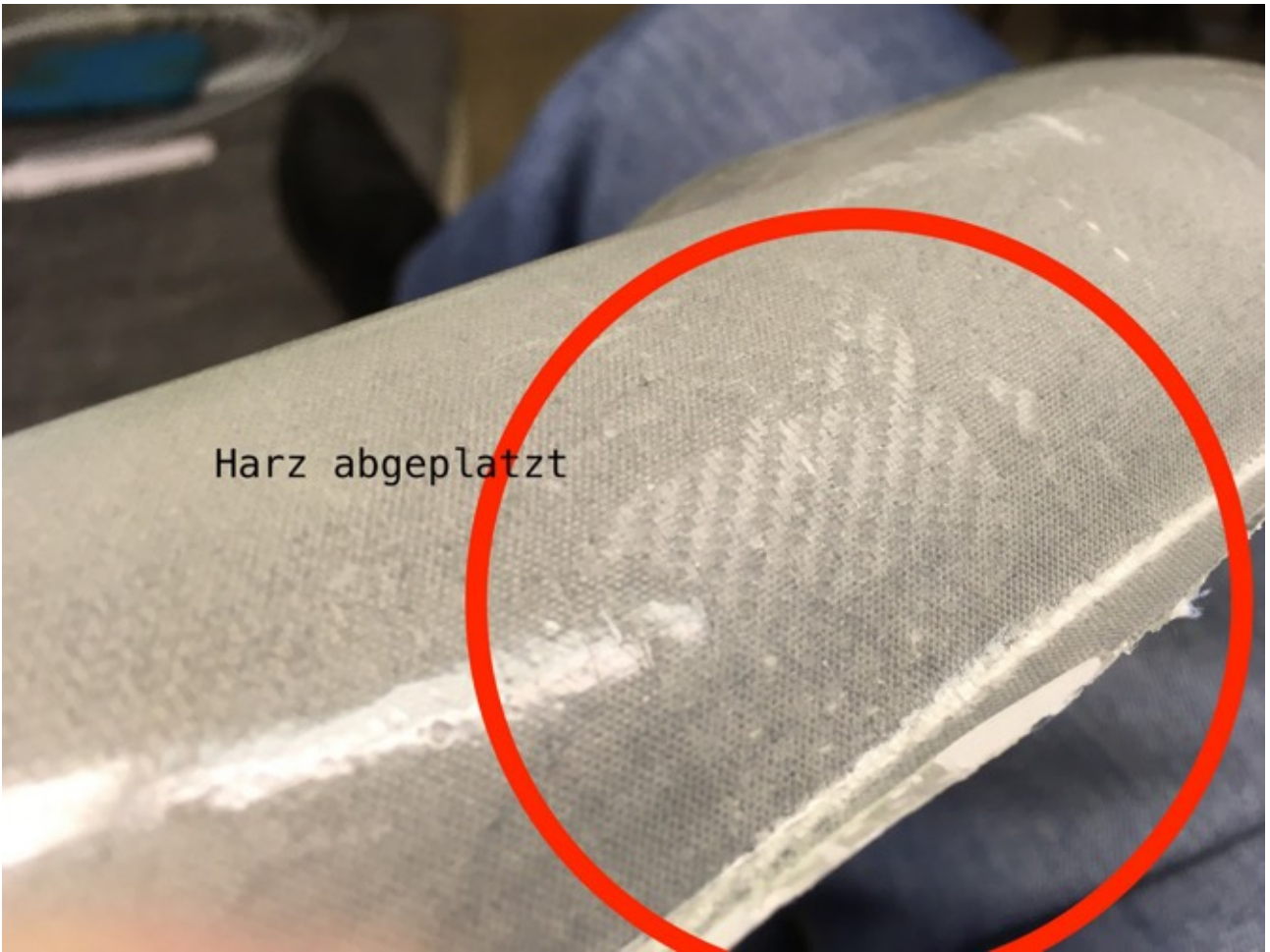
Abbildung 23: Harz abgeplatzt bis auf Faser
