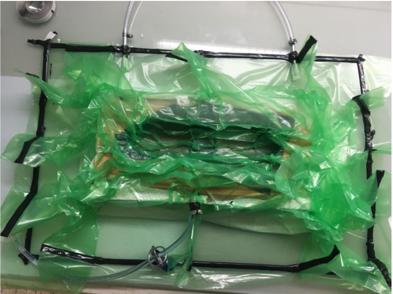
Abbildung 7: Vakuumfolie am 11.3. vor Entnahme des Bauteils
