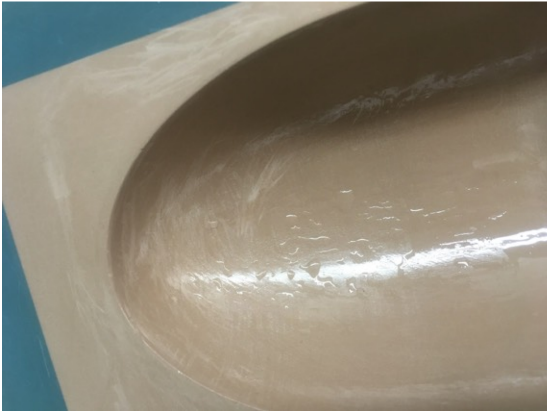
Abbildung 1: Tropfenbildung PVA auf W-99+ Trennmittel
