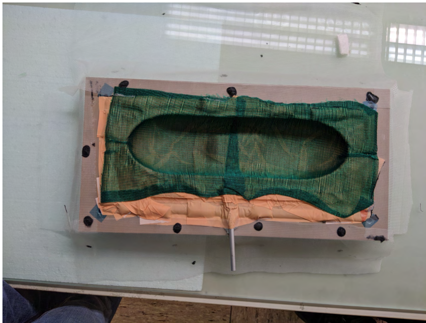
Abbildung 2: VAP-Membran nach dem Fertigungsprozess
