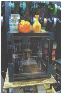
1 Teile des Schul-3D-Druckers Tutolino, der auf dem Anet A8 basiert, entstehen auch im 3D-Druckverfahren.
