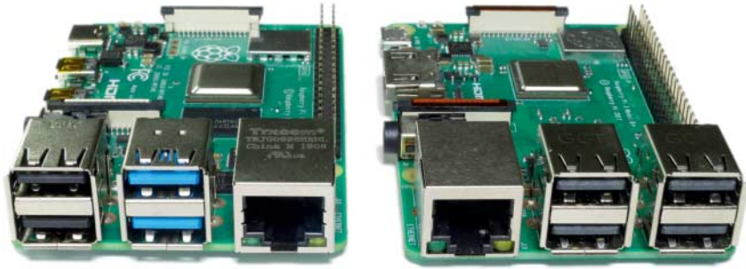
Im Vergleich zum Raspberry Pi 3 Model B+ (rechts) fallen die blauen USB-3.0-Buchsen und die neue Position des Ethernet-Ports auf.
