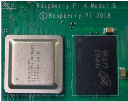
Herz des Raspberry Pi 4 Model B ist der Broadcom BCM2711 (silbern), der hier mit einem LPDDR4-SDRAM mit 4 GByte gekoppelt ist.
