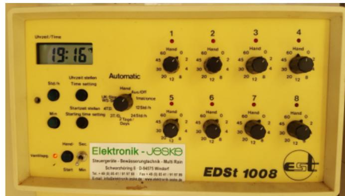
Es kann bis zu acht Tennisplätze manuell oder zeitlich gesteuert beregnen. Das Wasser zur Beregnung wird über Magnetventile ein- und ausgeschaltet. Die Technik die drin steckt verwendet einen damals häufig verwendeten 8085 Mikroprozessor. Mittlerweile ist das Gerät nicht mehr zu kaufen, die Reparatur im Fehlerfall kostet mehrere hundert Euro. Die vielen Schalter auf der Frontplatte sind nötig, um diverse Einstellungen bei der zeitlichen Steuerung zu ermöglichen.
